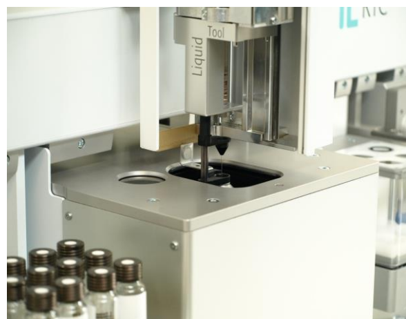
Abbildung 3: Zentrifuge als Teil der automatischen Epoxidierung.
